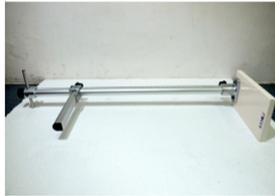
Gabungkan 2 bagian alat ukur: batang 1 (0–77 cm) dan batang 2 (78–135 cm) dari total 3 batang alat ukur Multifungsi. Lalu kencangkan batang ukur dan panel bagian kepala, kemudian pasang besi penopang agar alat geser dapat bergerak bebas.
