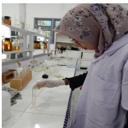
Pencampuran larutan Asam kromatofat 0,5 % dalam asam sulfat 60 %
