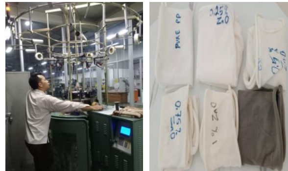
Gambar 7. Mesin Rajut Bundar dan Hasil Rajutan Kain
