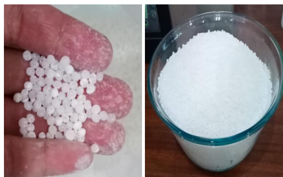
Gambar 1. Campuran PP dan Nanopartikel ZnO
