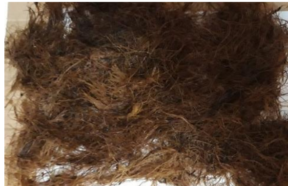
Gambar 1. Serat selulosa TKKS setelah proses delignifikasi
