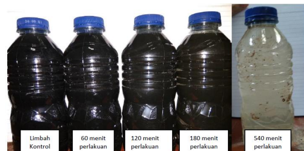
Gambar 9. Hasil olahan limbah menggunakan variasi waktu perlakuan limbah yang berbeda dengan kapasitas ozon sebesar 86,4 gram/jam
