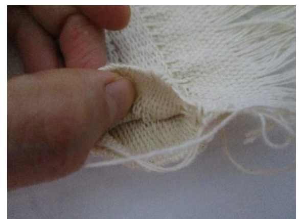
Gambar 7. Silangan atau ikatan yang terjadi antara lapisan kain bagian atas dan lapisan kain bagian bawah akibat dari teknik pick-up
