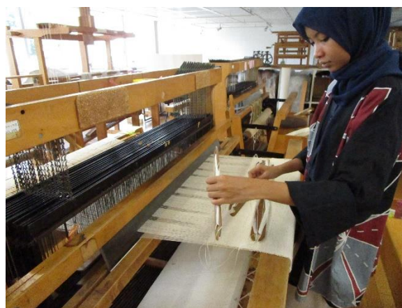
Gambar 4. Proses pembuatan prototip tahap dua, kain berukuran 60 cm x 100 cm dengan ATBM
