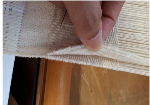
Gambar 5. Tampak lapisan dari kain rangkap yang dihasilkan dengan teknik double weaving yang dapat menjadi celah untuk benang konduktif
