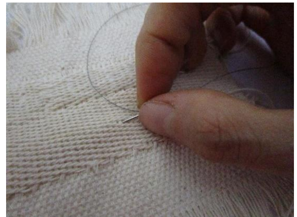
Gambar 6. Cara memasukkan benang konduktif ke dalam kain tenun double weaving dengan menggunakan jarum jahit
