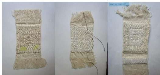
Gambar 2. Prototip awal penelitian dengan teknik double weaving berukuran 8 cm x 8 cm
