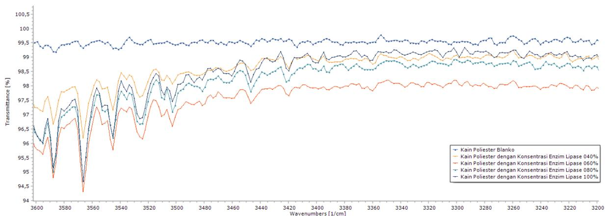
**Gambar 9.** Spektra FTIR pada wilayah 3600-3200 kain poliester sebelum (blanko) dan kain poliester setelah proses enzimatik pada konsentrasi enzim lipase 40%, 60%, 80% dan 100% *owf*
