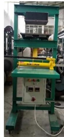
**Gambar 4.** Prototipe Mesin Kempa Panas
