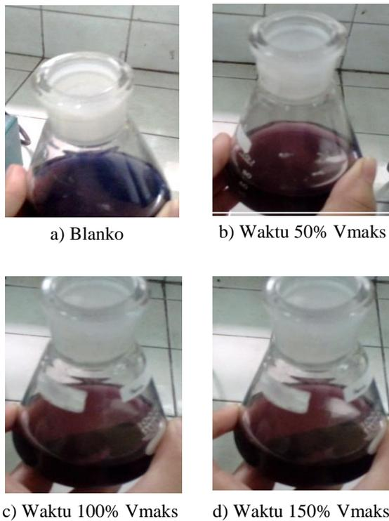
**Gambar 5.** Larutan *desizing* dengan variasi waktu Vmaks setelah ditetesi iodin
